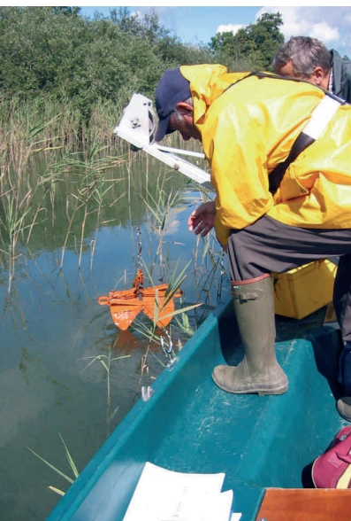
Lac Ilay (39) Prélèvement de sédiment
