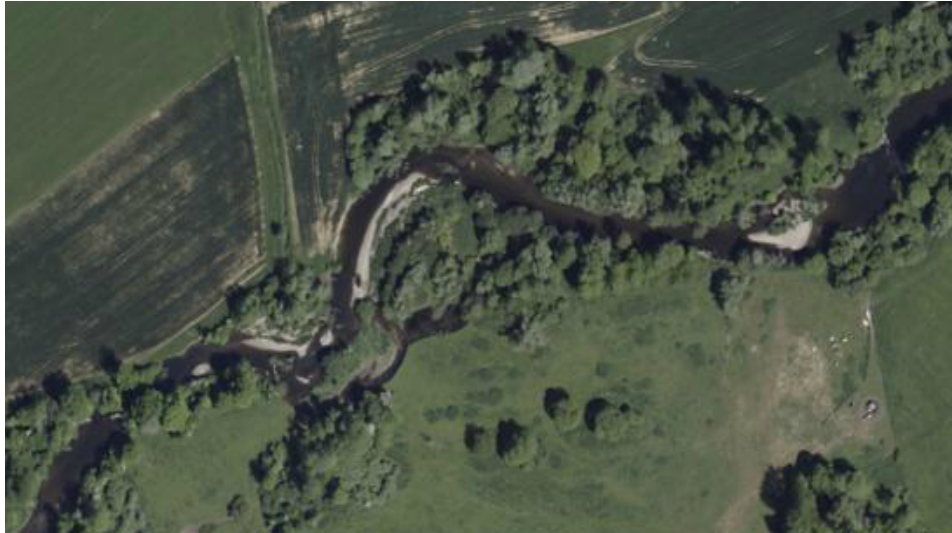
Figure 8 : Exemple de lit de type 3b - cours d'eau à méandres migrants - (la Lanterne, commune de Briaucourt, 70).
